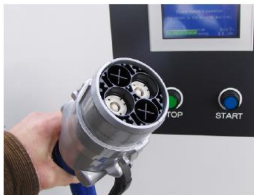
Slika 18. Tip 4 konektora (TEPCO konektor za punjenje prema CHAdeMO protokolu) [55]
