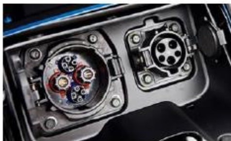
Slika 19. CHAdeMO (lijevo) i J1772 (desno) utičnica na Leafu [58]
